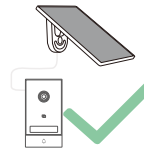
Sikring af, at strømkablet ligger naturligt uden spænding
